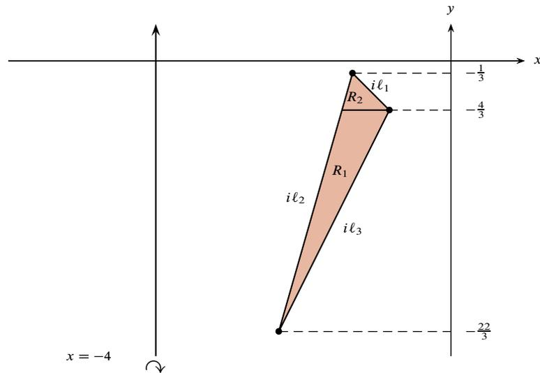
El área de las arandelas se calcula usando las distancias entre el eje de rotación  $x = -4$  y las gráficas de las funciones que definen las regiones:
