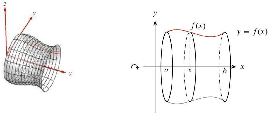
En este caso conviene tomar como eje para el cálculo del volumen al propio eje  $x$  (que es el eje de revolución) y no olvidar que cualquier sección transversal obtenida al intersecar al sólido con un plano perpendicular al eje  $x$  por un punto  $x$  entre  $a, b$  es un círculo. El área de ese círculo es
