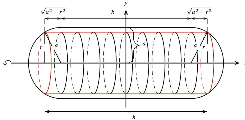
▼ Podemos suponer que el eje  $x$  es el eje de rotación del tanque. Una capa cilíndrica a distancia  $r$  del eje de rotación se muestra en la figura.
