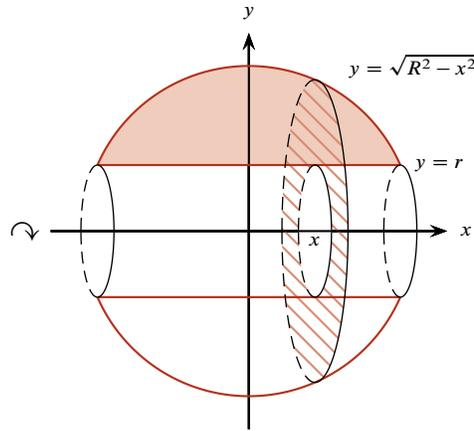
▼ Podemos imaginar la esfera con la perforación indicada, como el sólido generado al girar la región sombreada en la figura alrededor del eje  $x$ . Es claro, para cualquier sección transversal, que el radio exterior es  $f(x) = \sqrt{R^2 - x^2}$  y que el radio interior es  $g(x) = r$ , el cual debe cumplir  $r < R$ . Hace falta calcular los límites de integración. Para ello baste notar que el semicírculo  $y = \sqrt{R^2 - x^2}$  y la recta horizontal  $y = r$  se intersecan cuando:
