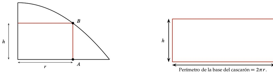
El cascarón cilíndrico se obtiene haciendo rotar el segmento  $\overline{AB}$  alrededor del eje  $y$  (el eje de rotación). Esta recta se encuentra a una distancia  $r$  del eje de rotación (radio del cilindro) y tiene una longitud  $h$  (altura del cilindro). Tenemos por lo tanto:
