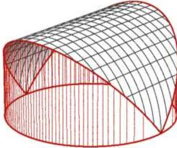
Una vez que visualizamos el sólido, para el cálculo de su volumen podemos elegir el eje  $x$  para integrar la función del área  $A(x)$ , donde  $-r \leq x \leq r$ . Como observamos antes, la longitud de la base del rectángulo que resulta al intersecar el sólido con el plano vertical paralelo al eje  $y$  y que pasa por el punto  $x$  es
