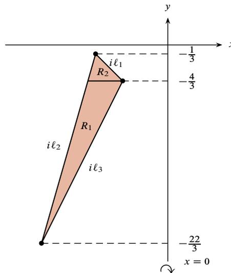
El área de las arandelas se calcula usando las distancias entre el eje de rotación  $x = 0$  y las gráficas de las funciones que definen las regiones:
