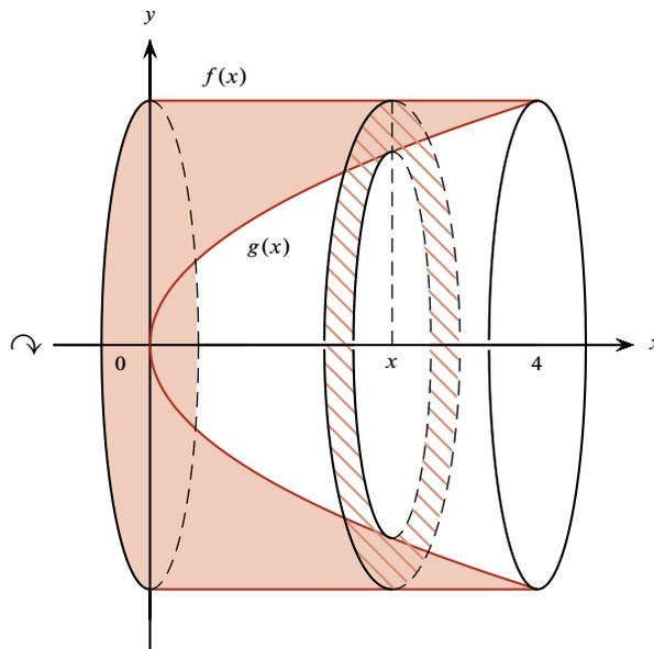
▼ El intervalo de integración para obtener el volumen es  $[0, 4]$  y las funciones para calcular los radios exterior e interior del corte transversal en  $x$  son  $f(x) = 4$  &  $g(x) = 2\sqrt{x}$ , respectivamente; así que el volumen se calcula:
