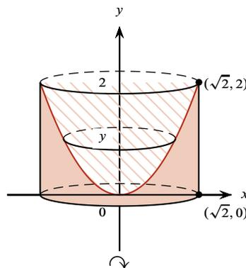
El sólido que se obtiene es un cilindro al que se le ha removido un volumen con forma de paraboloides de revolución.
