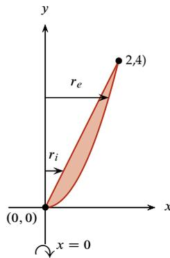
Para calcular ahora el área de la arandela se requiere medir los radios del eje de rotación  $x = 0$  a las gráficas de las funciones que definen la región:
