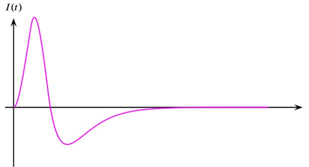
La corriente es prácticamente cero a partir del décimo segundo después del cierre del interruptor en el circuito. □
