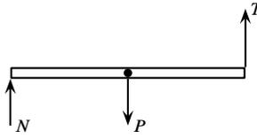
Donde  $P = mg$  es el peso de la viga,  $N$  la fuerza que el apoyo simple ejerce sobre la viga y  $T$  la tensión de la cuerda.
