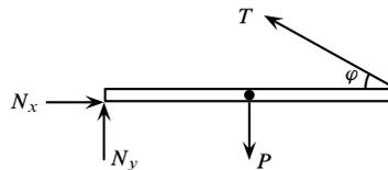
Donde  $P = mg$  es el peso de la viga,  $T$  la tensión de la cuerda y  $N_x, N_y$  son las componentes  $x, y$  de la fuerza que el apoyo articulado ejerce sobre la viga.
