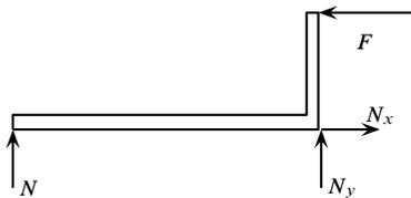
Donde  $N$  es la fuerza que ejerce el apoyo simple sobre la estructura y  $N_x$ ,  $N_y$  son las componentes  $x$ ,  $y$  de la fuerza ejercida por el apoyo articulado. Entonces el diagrama de cuerpo libre para la estructura es:
